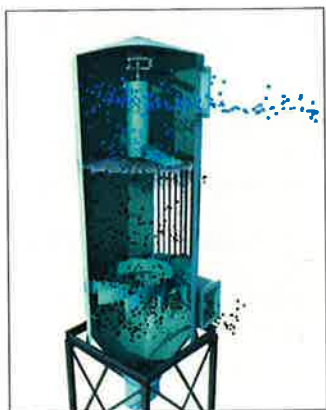
Prinzip der Mitteldruck-Abreinigung beim MCF-Filterssystem
